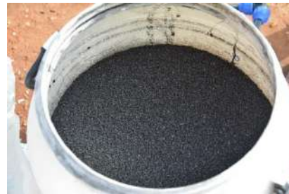
Abbildung 64: Feinfilter nach Befüllung mit Maisspindelbiokohle 1-4 mm (R. Voß)
