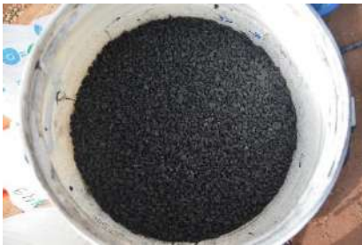
Abbildung 63: Grobfilter nach Befüllung mit Maisspindelbiokohle 4-8 mm (R. Voß)
