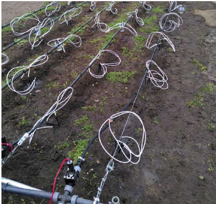
Abbildung 94: Gravitationsbasierter Versuchsaufbau Spindelschlauch (Mikrospinne)
