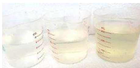
Abbildung 73: Wasserproben von Zulauf, nach dem Grobfilter und vom Ablauf (v.r.n.l.) (S. Krüger).
