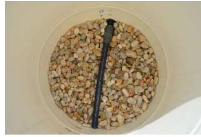
Abbildung 62: Unterste Stüttschicht mit Drainagerohr des Feinfilters (R. Voß).
