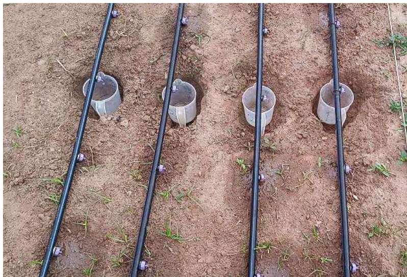
Abbildung 111: Anordnung Messbecher zur Ermittlung des Ausflusses der Palaplast-Emitter; Bild (©Agorde, 2022)
