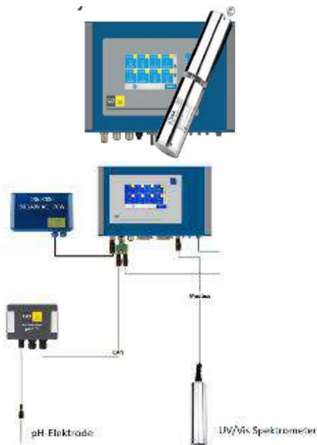
Abbildung 54: Mess- und Steuerungssystem „BlueBox“+ Spektrometer (GO Systemelektronik GmbH).
