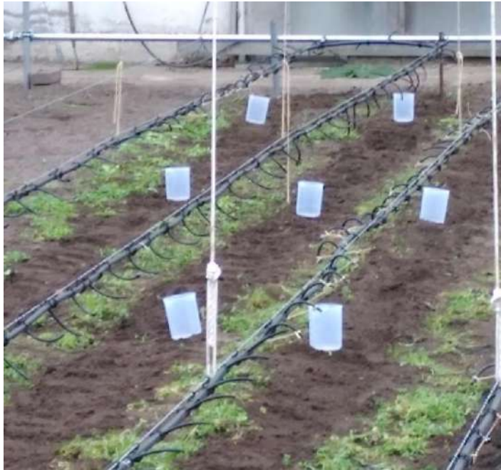
Abbildung 86: Versuchsaufbau des Mikroschlauches im Gravitationsbetrieb.
