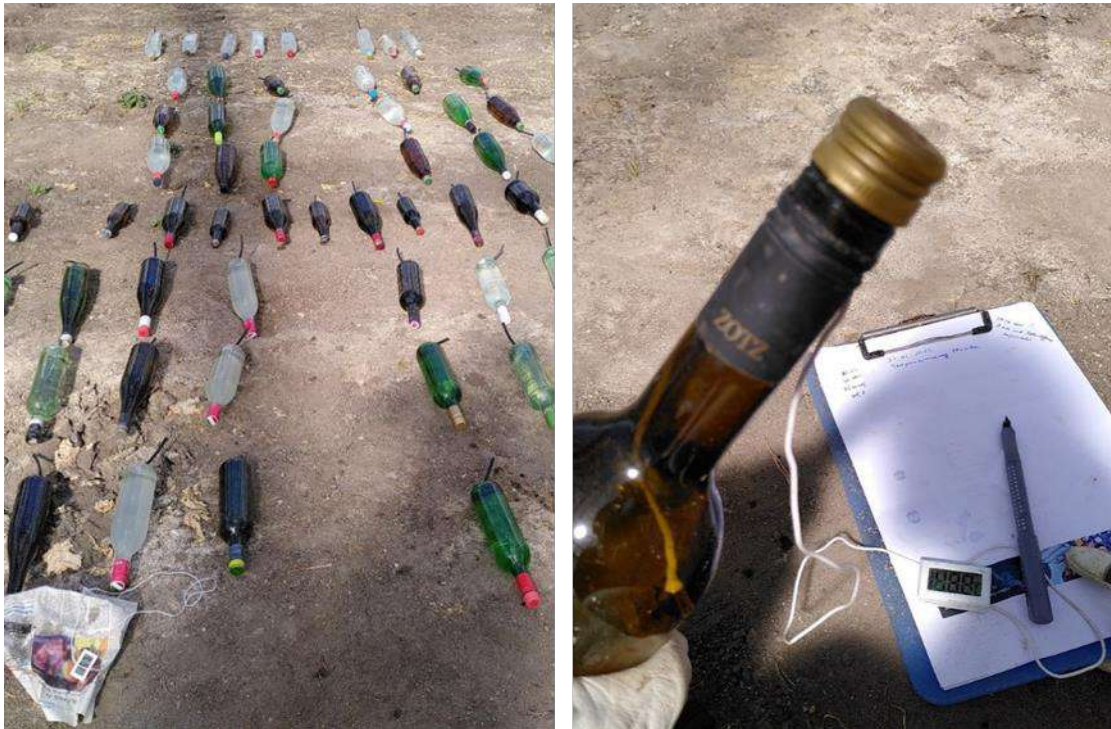
Abbildung 106: Experimenteller Aufbau zur Wassertemperaturmessung in Flaschen 2022. Pathogenreduktion durch Hitzeeinwirkung
