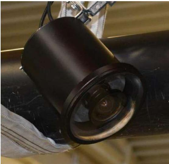
Abbildung 97: Unterwasserkamera mit Umhausung
