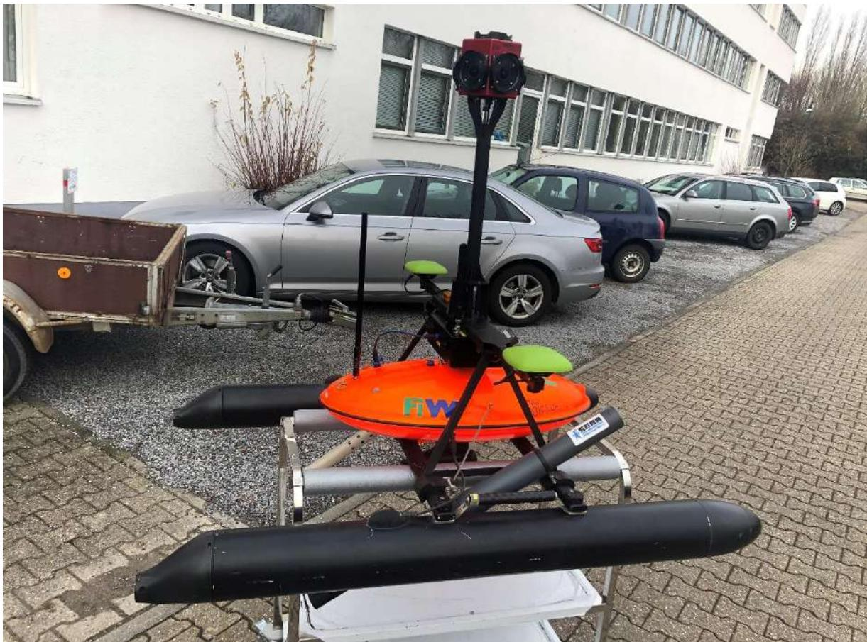
Abbildung 50: RiverBoat mit Überwassermappingeinheit und den beiden MPS
