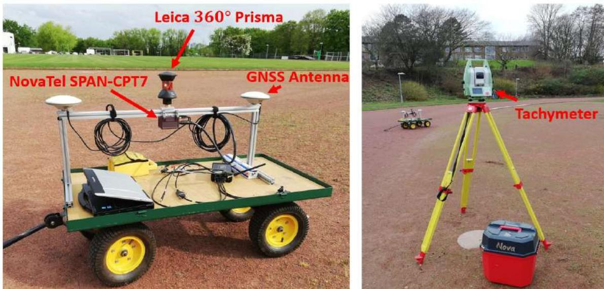
**Abbildung 118:** Geräteaufbau für die Testfahrten
