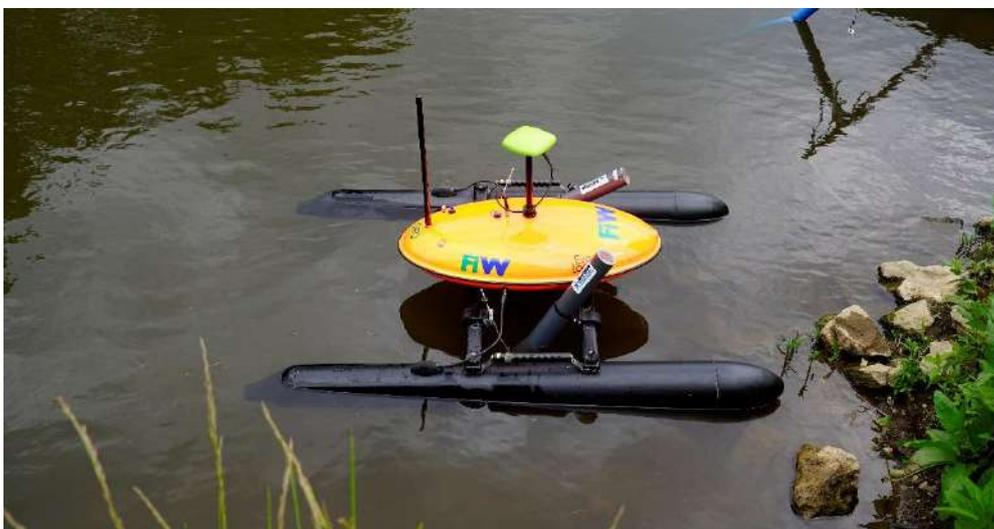
Abbildung 3: Das RiverBoat mit zwei Multiparametersonden
