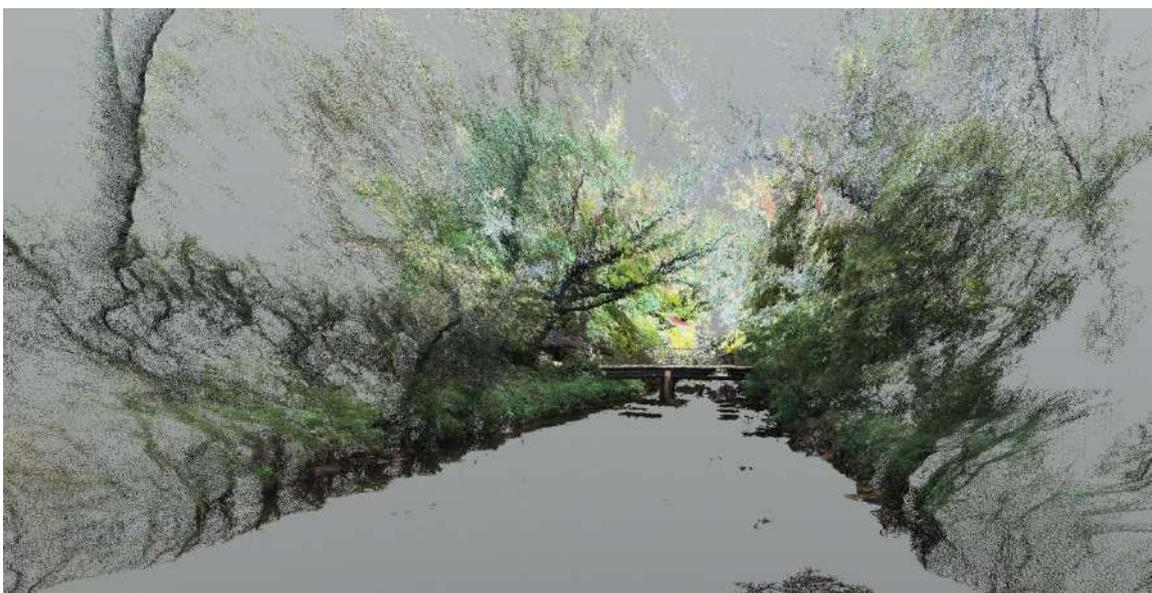
Abbildung 7: Bildbasierte Punktwolke berechnet aus den Panoramaaufnahmen (Erft)
