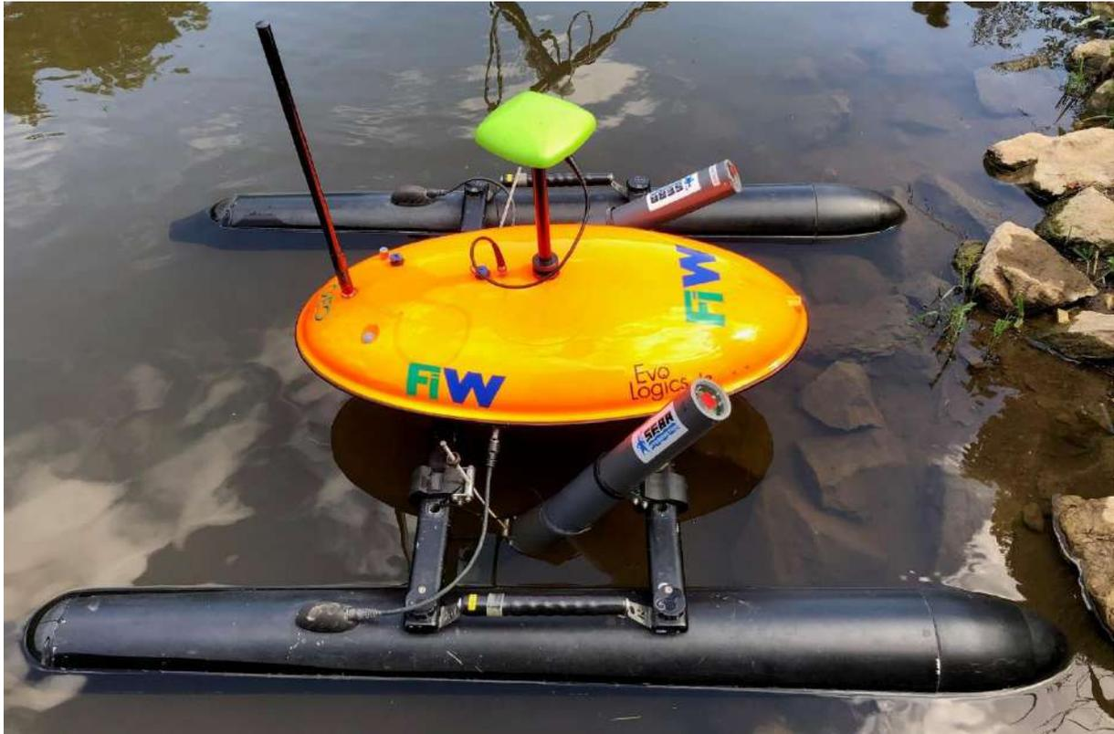
Abbildung 49: RiverBoat mit beiden SEBA Multiparametersonden parallel fixiert
