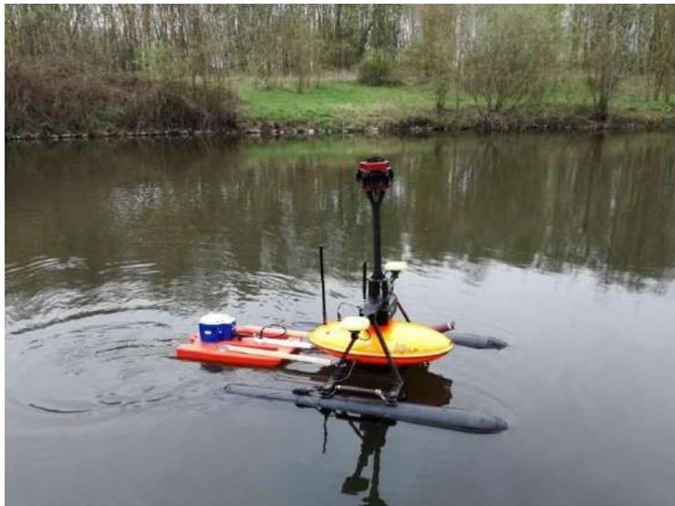
**Abbildung 16:** RiverBoat mit 360°-Kamera, MPS und ADCP auf der Rur
