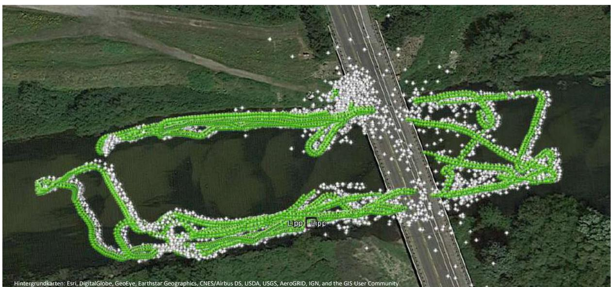
Abbildung 70: GNSS-Positionen ohne Korrektur (grau) und mit Korrektur (grün)
