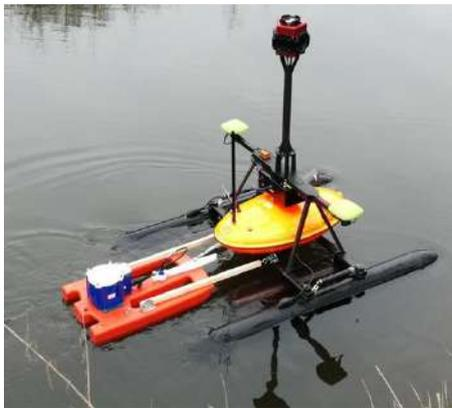
**Abbildung 55:** RiverBoat mit ADCP Anhänger
