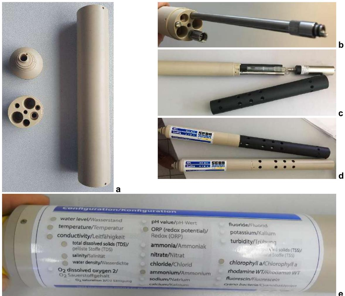
Abbildung 47: (a) PEEK-Kunststoff-Bauteile für den Sondenkörper mit Sondenrohr, Trägerteil und Stecker. (b) PEEK-Trägerteil mit Extension für Chlorophyll- oder Trübungssensor. (c) SEBA MPS mit Trübungssensor, Sauerstoffsensor, pH-Elektrode und Nitratsensor und schwarzem PVC
