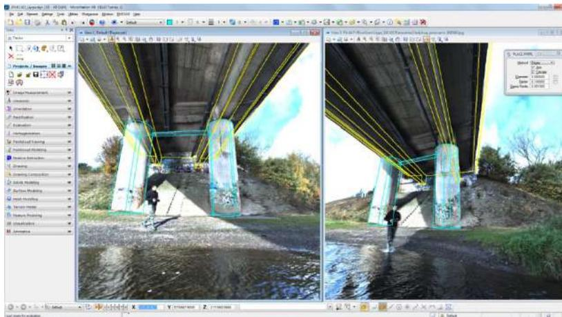
**Abbildung 71:** Panoramadarstellung im photogrammetrischen Auswertesystem PHIDIAS
