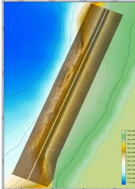
**Abbildung 78:** Höhenlinienmodell eines bergrechtlich gesperrten Böschungsbereiches mit Integration einer Sidescanaufnahme zum Erkennen von Rutschungsgefahren (Speicherbecken Borna) Geo-DV
