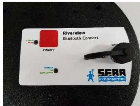
**Abbildung 20:** Foto mit Ausschnitt der Winde mit integriertem SEBA Bluetooth-Modul
