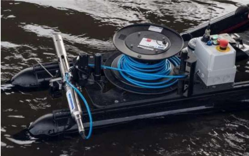
Abbildung 45: Trägersystem mit Kabelwinde sowie SEBA-MPS
