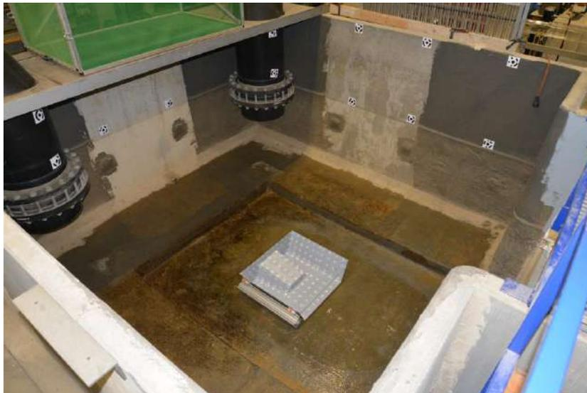
**Abbildung 102:** Vorbecken in der Versuchsrinne des IWW mit der für die Kalibrierfahrt platzierten Kalibrierkulisse
