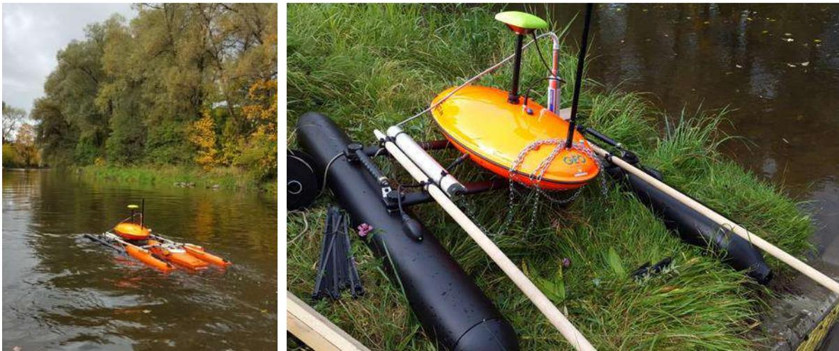
Abbildung 25: RiverBoat mit ADCP und MPS auf der Wertach
