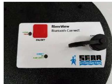
**Abbildung 44:** Foto mit Ausschnitt der Kabelwindenaufsatz mit integriertem SEBA Bluetooth-Modul
