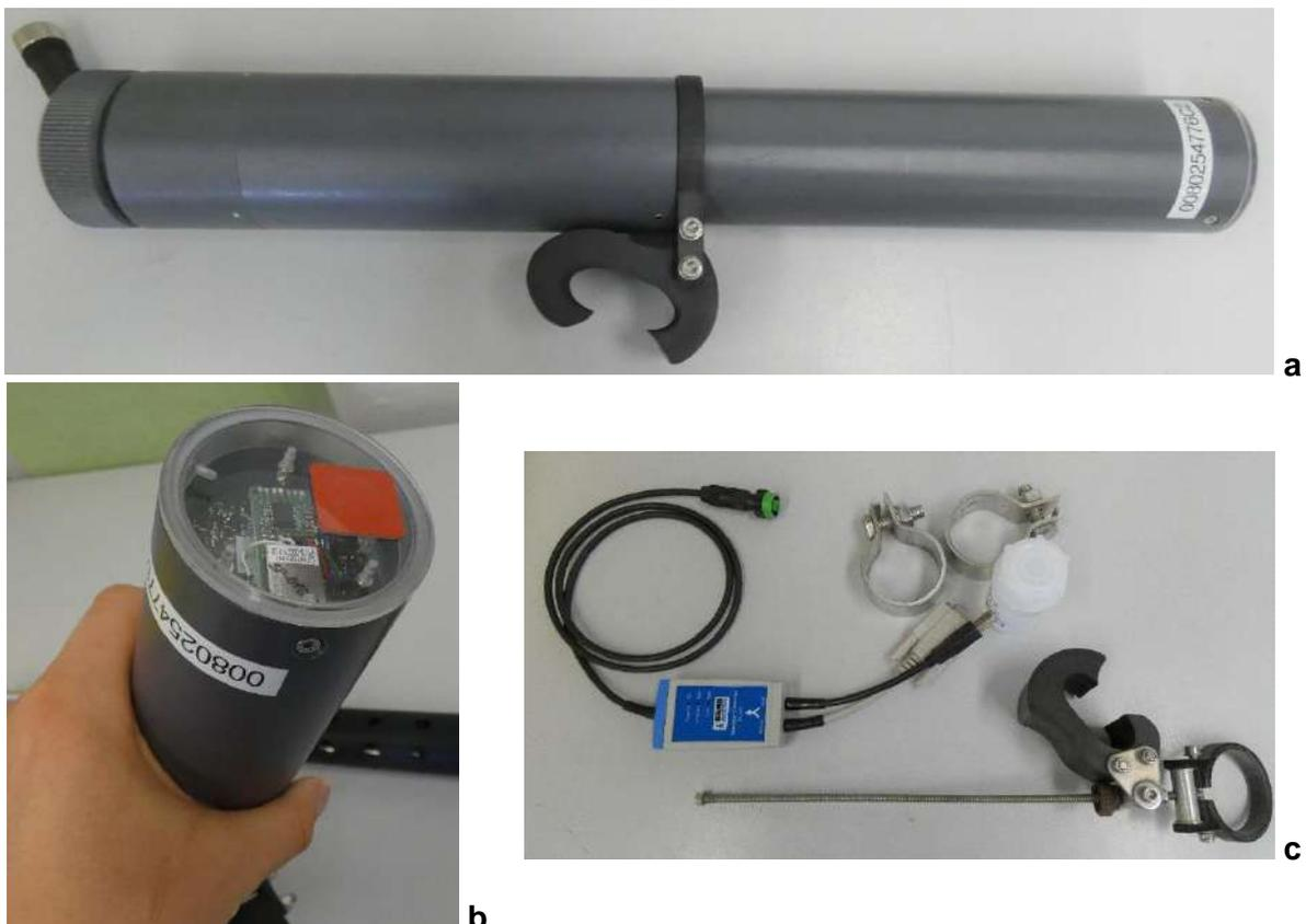
**Abbildung 46:** (a) Kunststoffköcher mit Befestigungsvorrichtung zur Fixierung der SEBA MPS am RiverBoat. (b) Integriertes Bluetooth-Modul im Schutzköcher. Unterhalb des Moduls befindet sich die integrierte Akkuversorgung (nicht sichtbar) der MPS. (c) Zubehör zur Befestigung
