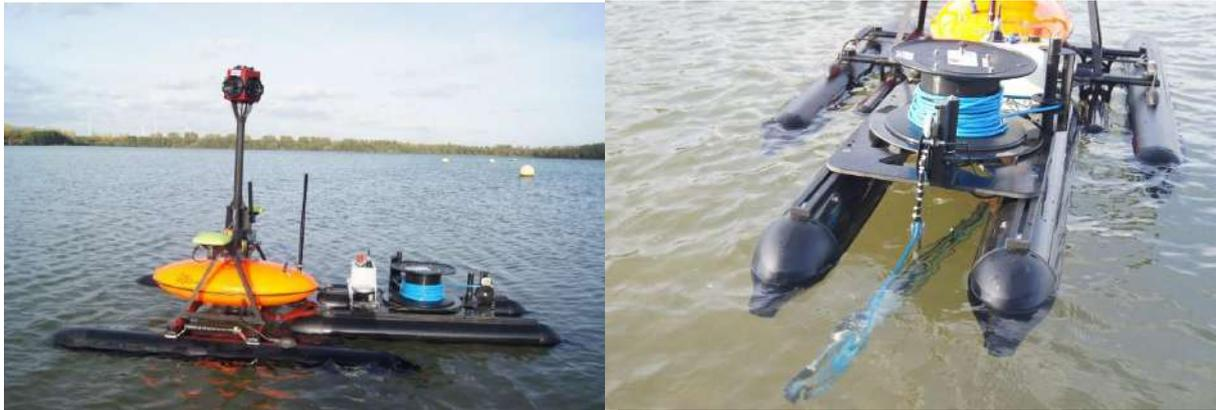
**Abbildung 53:** Das RiveBoat mit integriertem Trailer mit Winde, um die MPS (SEBA) in verschiedene Wassertiefen herabzulassen.
