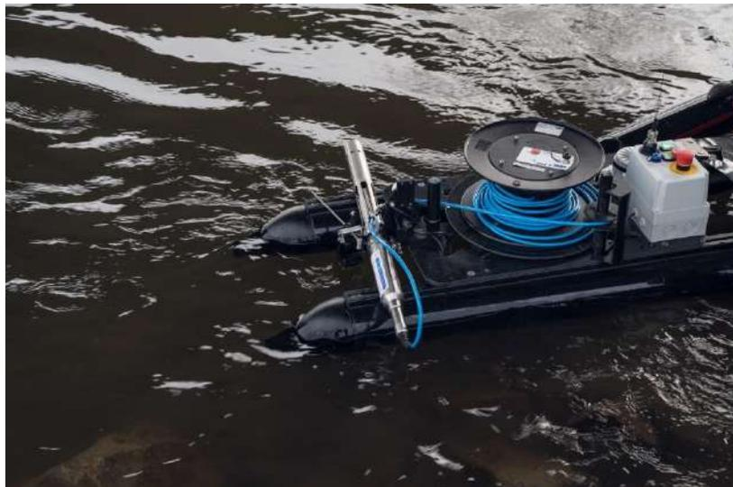
**Abbildung 37:** Modularer Anhänger "Trailer" mit fernsteuerbarer Winde zum Herablassen der MPS in verschiedene Wassertiefen.
