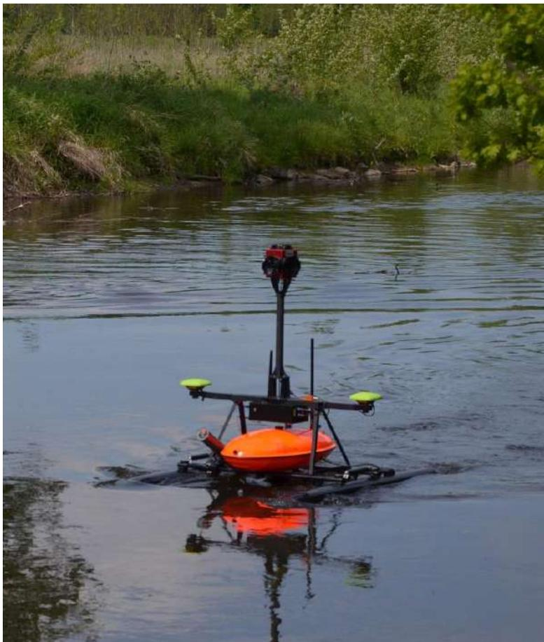
Abbildung 13: RiverBoat mit aufgesetztem 360° Kameramodul und MPS
