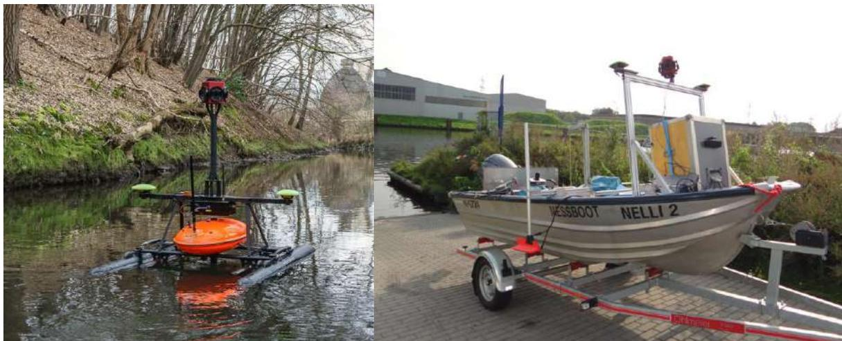
Abbildung 2: Das RiverBoat (links) und das Messboot Nelli 2 (rechts) des IWW RWTH Aachen
