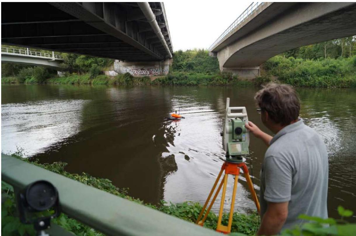
Abbildung 15: RiverBoat mit Reflektor und automatischer Verfolgung mit einem Tachymeter
