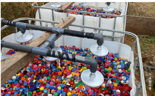
Pilotanlage dezentrale Wasserwiederverwendung zur urbanen Bewässerung. © FiW e. V.
