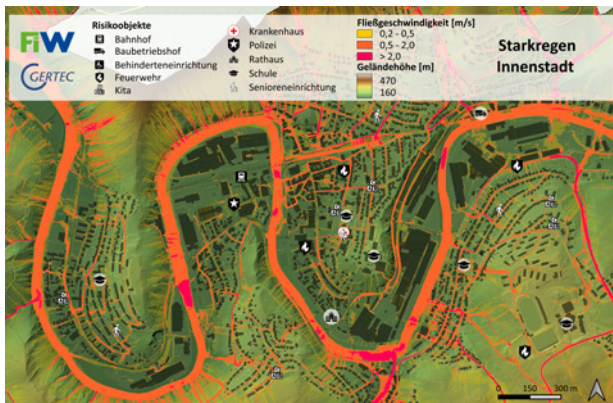
Fließgeschwindigkeiten bei einem extremen Starkregenereignis mit einer Intensität von 90 mm in der Innenstadt Werdohls. (Datenquelle: Starkregengefahrenkarte des Märkischen Kreises). © FiW e. V.
