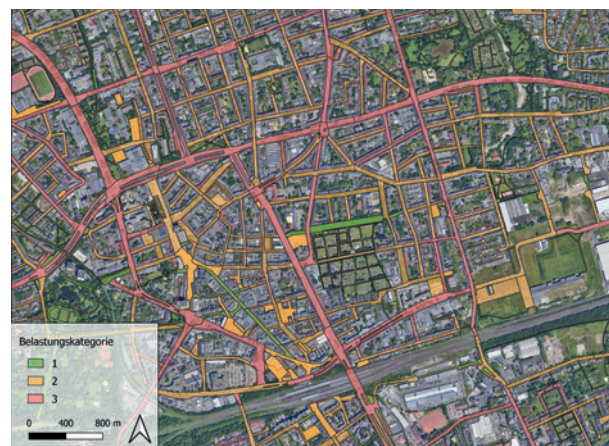
Abbildung 2: Potenzielle Belastungskategorien unterschiedlicher Straßenabschnitte im Untersuchungsgebiet Gelsenkirchen nach ihrer Kfz-Frequenz. © FiW e. V.
