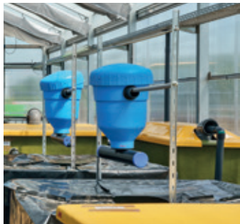
▲ Ultrafiltrationsmembranmodule (links); mit schwarzer Folie abgedunkelte Tanks mit automatischem Fütterungssystem für die Aquakultur (rechts).
