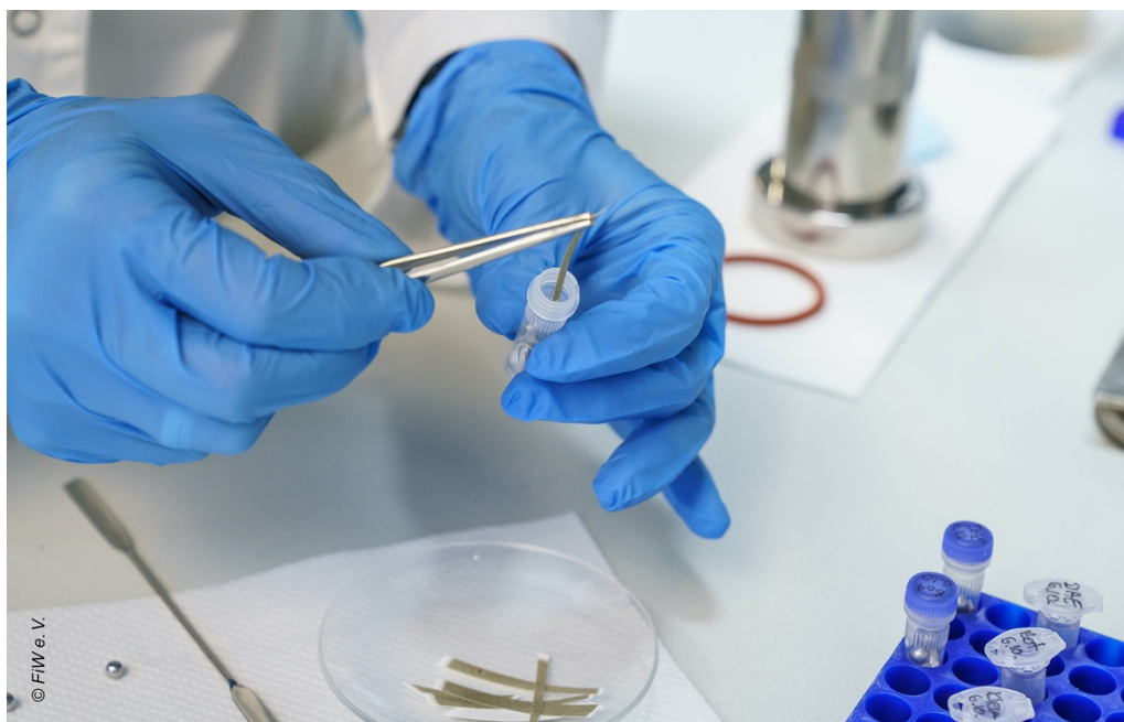
Probenvorbereitung für Omikron-Analysen im abwassertechnischen Kooperationslabor (© FiW e. V.)
